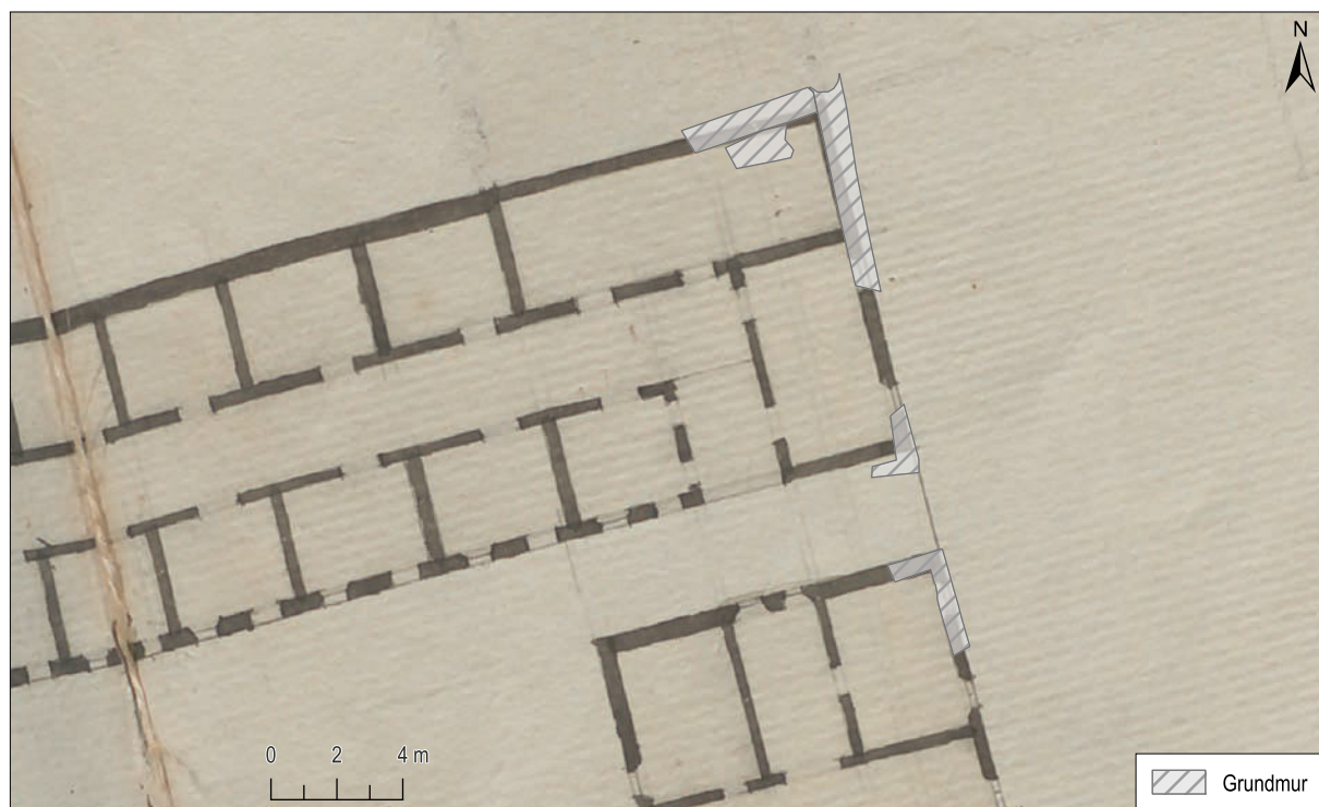
Figur 209. Planritning över grundmurarna till kontextgrupp 20 och 21 på bakgrund av en uppmättningsritning av Carlberg från 1757. Stockholms stadsarkiv, GS 144-20-022 (Public Domain). Skala 1:250.
