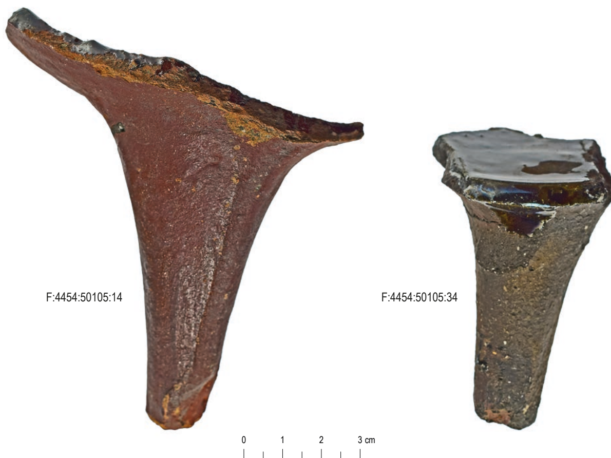
Figur 83. Exempel på felbränd keramik från krukmakeriavfallet, där godset spruckit under bränningen varpå glasyr runnit in i sprickbildningen. Skala 1:1
