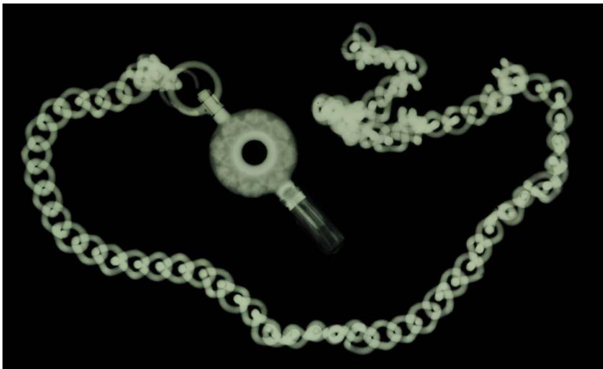
Kedjans nyckel röntgas för att få en uppfattning om dess status.
