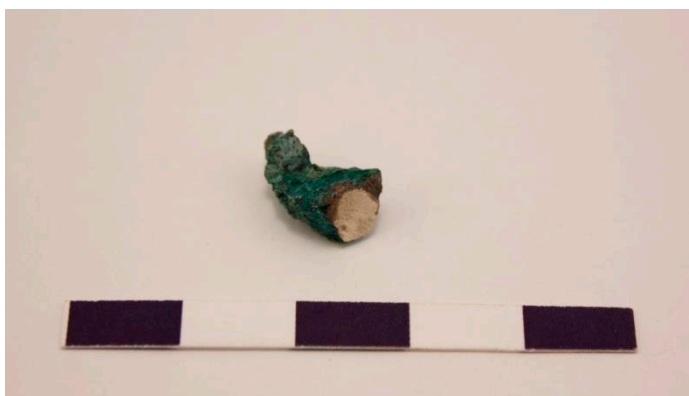
Figur 4. FI 266:2282:1. Den mindre smältan har delats för analys och en tydlig metallyta framträder.
