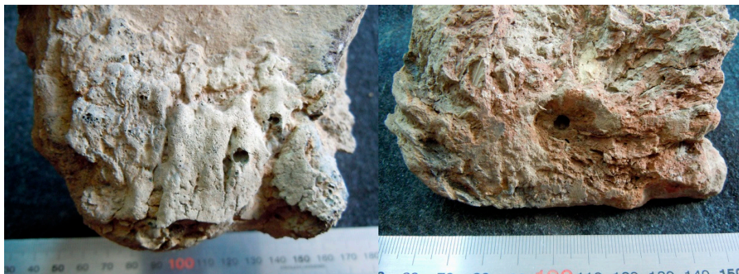
Fig.1. L2013:2505. Till vänster bild på yta av tegelsten med sintrad lerfodring (a). Till höger närbild på tegelstenens växtmagrade gods (b) (2117:21705).
