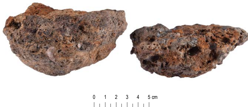
Figur 24. Exempel på runda sekundärsmidesskällor som hittades i påförda lager KL 333 och 337 vid strandkanten (Fnr 333:9988:4 och 337:10159:2). De har en heterogen sammansättning med inslag av sand och träkol i bottenpartiet. Skala 1:2.
