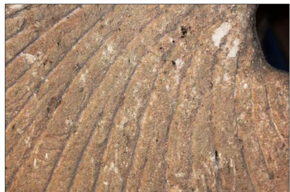
Figur 12. Huggna spår i kvarnstenens släta sidor som maler och transporterar ut mjölet över malstenarnas kanter. Kvarnstenen kommer från en vind- eller vattendriven kvarn.
