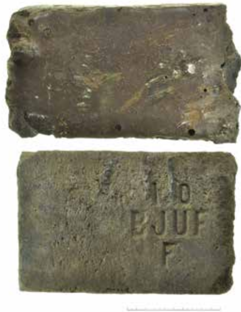
Figur 16. Gjuten slaggsten och en eldfast tegelsten från Bjuvs tegelbruk i Skåne. Skala 1:4.
