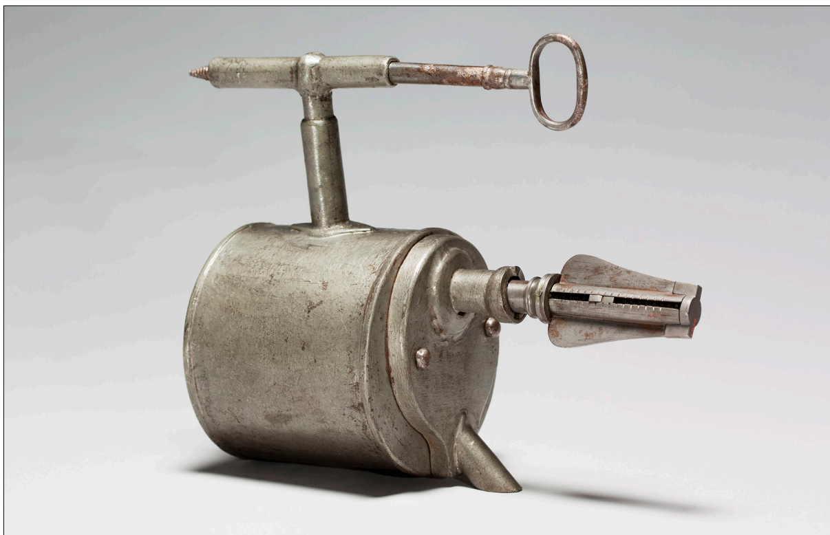
Figur 6. "Polhems konstige tapp". Sattes i tunnor för avtappning av dyrbara vätskor, till exempel vin eller brännvin, och mätte mängden som tappades ut. Fungerade även som lås. Polhem hävdade att den kunde användas för att kontrollera tjänstefolkets brännvinskonsumention. Tekniska museet, bildID: TEKS0020975. CC BY 4.0
