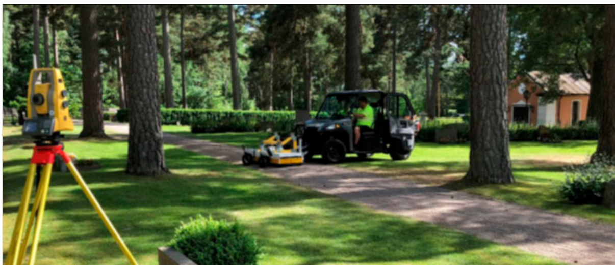
Astacus 16-kanals MIRA georadarsystem monterat på en mindre trädgårdstraktor. Positionering av mätdata görs i realtid med totalstation eller RTK GPS.
