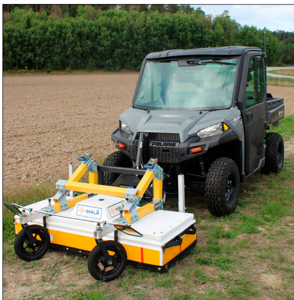
Figur 8. Georadarsystem monterad på en mindre trädgårds-traktor.
