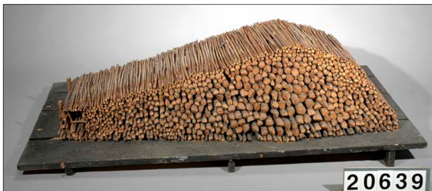
Figur 7. Modell av liggmila. Foto: Per Ivar Lindekrantz, Tekniska museet, bildid: TEKS0022274. CC BY 4.0
