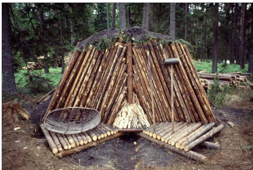
Figur 17. Resmila i genomskärning, modell. Skogsmässan, Elmia, Jönköping 1983. Foto. SLU:s externa mediabank, bildid dia_ssko_30_1.
