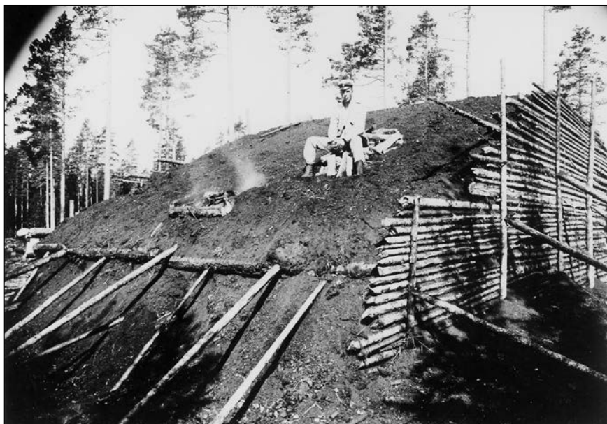
Figur 8. Liggmilans täckning och balkro är på plats och det är dags att tända elden. Fröbensbenning, Bjurfors, Västmanland 1918 SLU:s externa mediabank, bildid: 13636.
