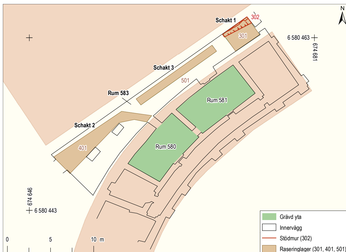
Figur 13. Rum 583 med de påträffades raseringslagren och stödmuren i schakt 1. Mot bakgrund av Fastighetskartan, skala 1:250.
