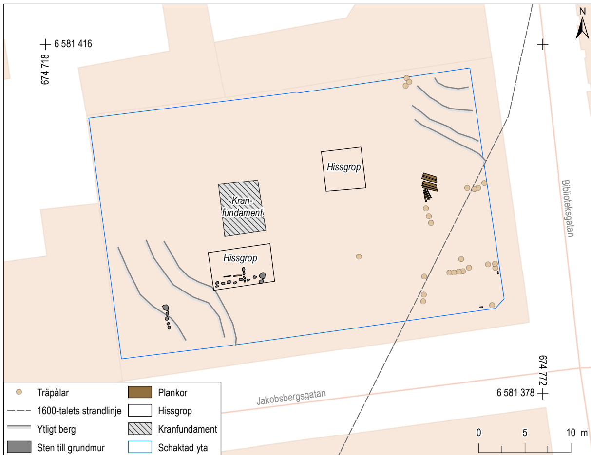
Figur 6. Schaktet med samtliga anläggningar. I schaktet grävdes först för hissgröpar innan hela området banades av och berg i dagen sprängdes bort. Mot bakgrund av Fastighetskartan (urval bebyggelse och vägar), skala 1:400.
