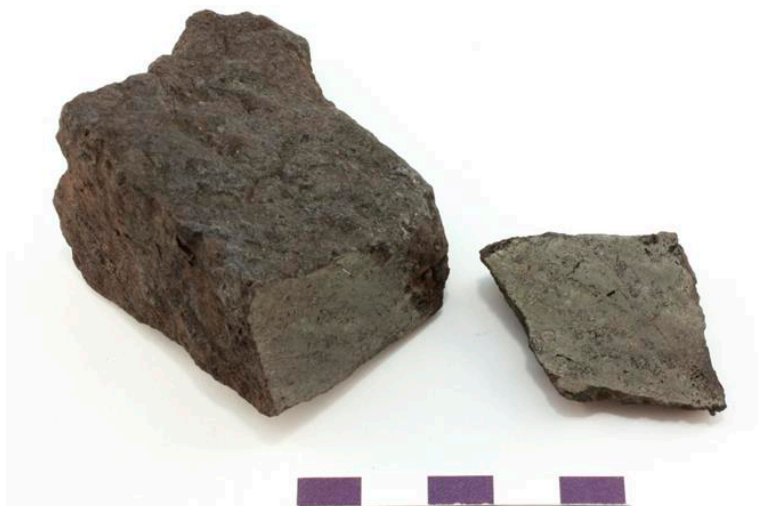
Figur 4. Prov 124, bokad malm från malmbås i östra längan. Vänstra biten analyserades totalkemiskt (203 g) medan den högra preparerades till tunnslip.
