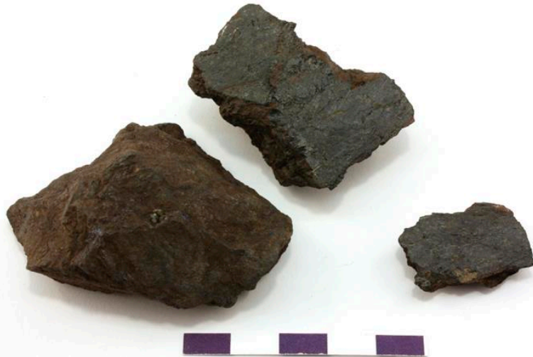
Figur 5. Prov 233, bokad malm från hyttbacken vid västra längan. 137 g analyserades totalkemiskt. Den högra biten preparerades till tunnslip.
