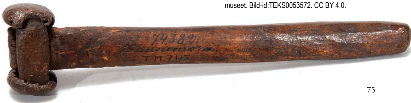
Figur 61. Hammare för skrädning av malm använd vid Dannemora gruvor. Foto Peter Häll, Tekniska museet. Bild-id:TEKS0053572. CC BY 4.0.
