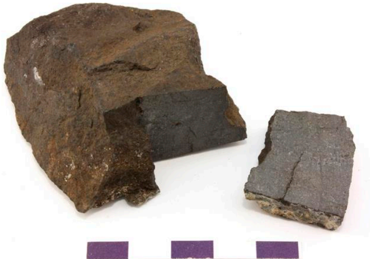
Figur 6. Prov 258, malm från under plankor i malmbås i västra längan. Den vänstra biten (135 g) analyserades totalkemiskt medan den högra preparerades till tunnslip.
