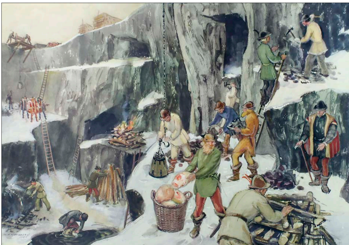
Figur 20. Gruvbrytning med hjälp av tillmakning. Bergsbruk under 1500-talet. Skolplansch av Olle Hjortsberg. Bild: Sörmlands museum. Bild-id: SLM 54150. CC BY-SA 4.0.
