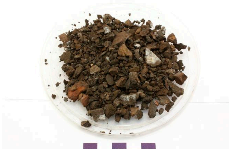
Figur 8. Prov 225, grusigt material från mellan golvplankor i malmbås i västra längan. 100 g analyserades totalkemiskt.
