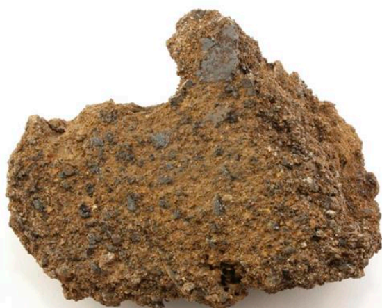
Figur 9. Prov 257, hopkittat material från malmbås i västra längran. 109 g analyserades totalkemiskt.
