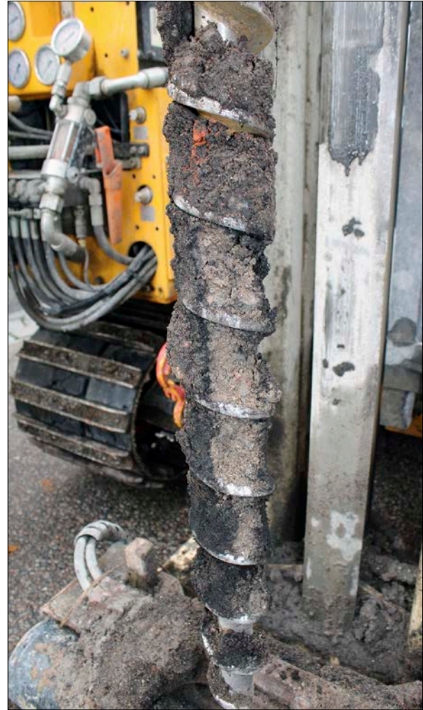
Figur 13. Borrhkärna från borrhpunkt 107, nivå 1–1,5 meter under gatunivå. Bilden visar hur materialet i skruvborren skadades i samband med upptagning. I dess högra halva syns sand som dragits med upp, sannolikt från nivå 0–1 meter under gatunivå. Möjligen skrapades kulturlagret av på grund av den nivå med sten som påträffades på 0,6 meters djup. Foto från nord – nordost.
