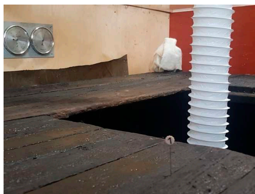
Bild 17-18: Sumpen torkning kontrolleras genom att försöka sänka luftfuktigheten i boxen gradvis utifrån mätning av träets vattenhalt. På bilderna syns avfuktaren med slangar för in- och utförsel av luft samt på bilden till höger ses kontrollpunkt 1 av 3 för mätning av fukthalt.
