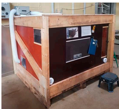
Bild 17-18: Sumpen torkning kontrolleras genom att försöka sänka luftfuktigheten i boxen gradvis utifrån mätning av träets vattenhalt. På bilderna syns avfuktaren med slangar för in- och utförsel av luft samt på bilden till höger ses kontrollpunkt 1 av 3 för mätning av fukthalt.
