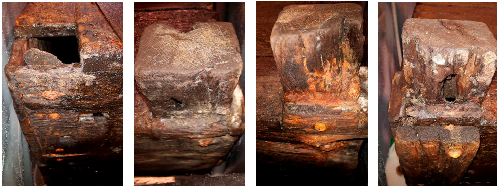
Bild 6-9: Fisksumpens hörnstolpar innan konservering (stolpe 1-4 medsols). På hörnstolpe 4 kan man se den övre änden av den lodräta bräda som täcker ett större hål i sumpen. Materialet är nedbrutet och starkt kontaminerat med järnkorrosionsprodukter.
