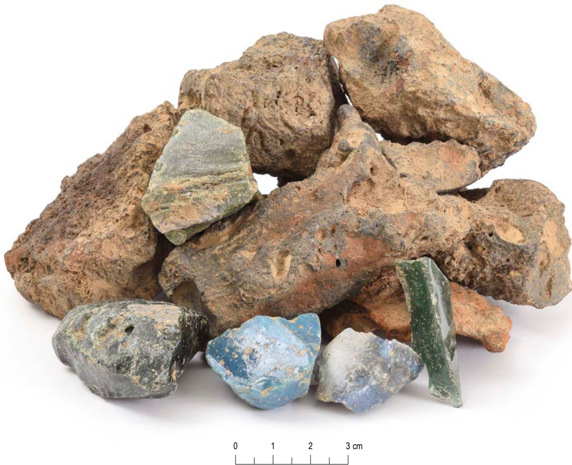
Figur 16. Ett urval av det masugnsslagg och blästerslagg som påträffades inom boplatsoområdet. Skala 1:1.
