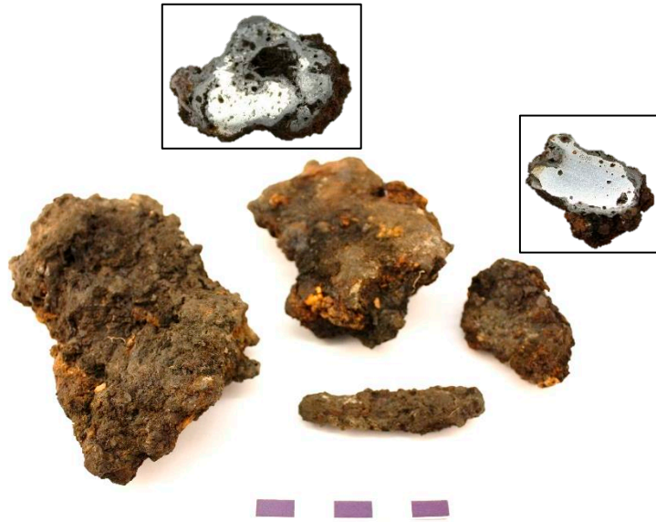
Figur 15. Del av 122:231, rostiga magnetiska klumpar. De båda överst till höger har delats. Infällda foton (något förstorade) med tvärsnitten visar ett järn med mycket hålrum (till vänster) och ett som är betydligt tätare (till höger).
