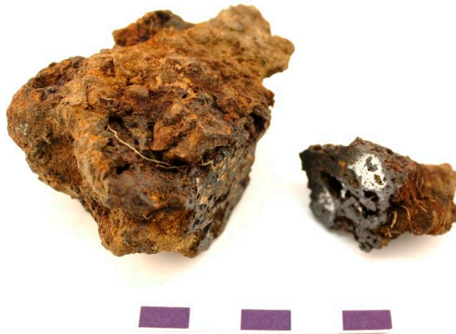
Figur 12. Magnetisk klump från 204:1214. Delat tvärsnitt (till höger) som visar metallen och rikligt med hålrum.
