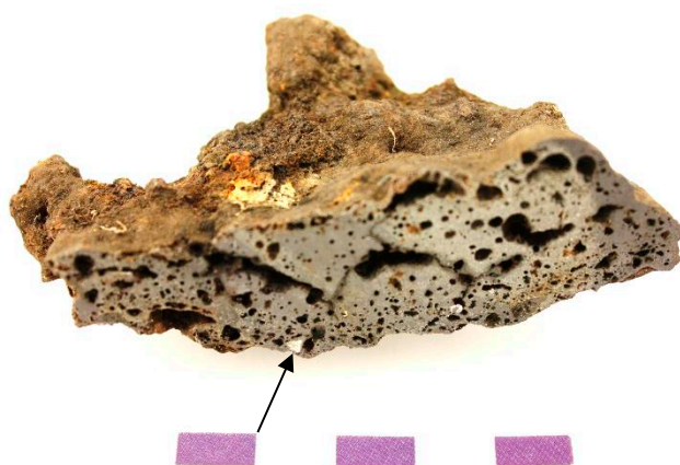
Figur 14. Del av 122:231, slagg i delat tvärsnitt med järndroppar och ett litet järnfragment (vid pilen) längs botten.
