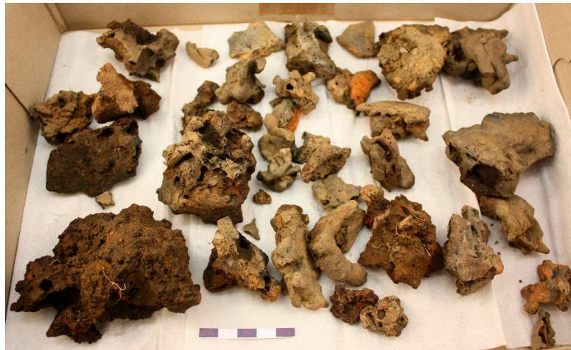
Figur 5. Del av 186:1307 som visar ett blandat material som också ses generellt: stearinformade slagger, oregelbundna klumpar som är trögflutna och porösa, samt tätare slagger som stelnat mot lera.
