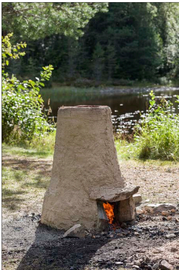
Figur 14. Experiment med järnframställning i blästugn vid Nya Lapphyttan 2017. Foto: Kenneth Sundh.
