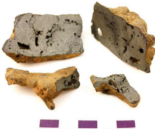
Figur 7. Från 186:1212. Delade tvärsnitt på några typiska stearinformade slagger med enstaka tunna strängar (nederst), eller flera på varandra (överst). Kontakterna mellan strängarna kantas av hålrum (porer), medan slaggen generellt är tät (lite hålrum).
