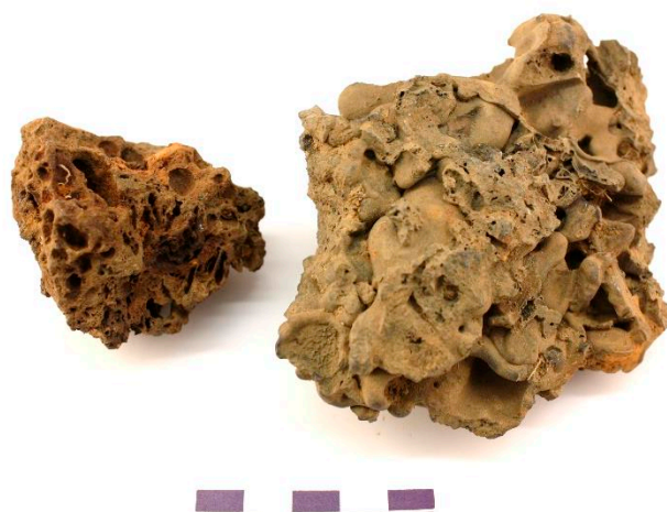
Figur 8. Från 186:1212. Exempel på en större slagg uppbyggd av flera tunnare täta slaggsträngar (till höger) och en porösare utan tydliga slaggsträngar till vänster.
