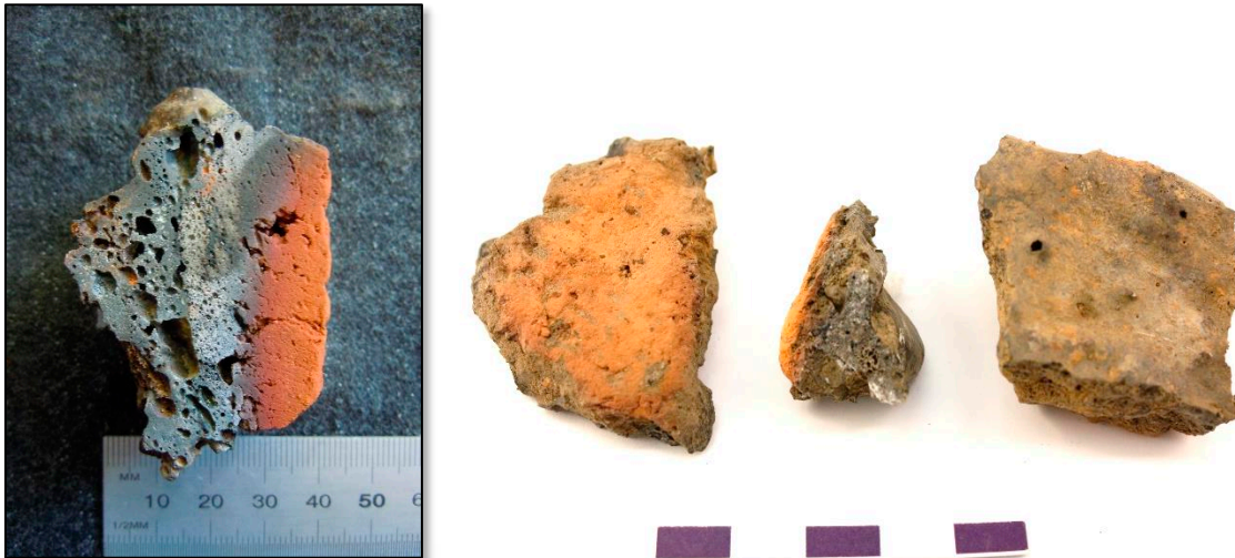
Figur 1. Från 186:1212. Exempel på fragment av lera. Till vänster den rödbrända sidan, till höger den motsatta smälta sidan (insidan) också med tunt slaggsikt. I mitten ett fragment som visar tvärsnittet med övergång mellan dem. Den infällda bilden på en snittad ugnsvägg (foto: O. Stilborg) visar tydligt övergången från ugnsväggens rödbrända utsida (till höger) via en smält zon av lera till insidan (till vänster) med ett grått slaggsikt.
