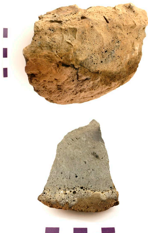
Figur 10. Från 186:1234. Tät, lättfluten slagg som har stelnat mot lera. I tvärsnitt (av en mindre bit) ses den smälta kontakten mellan slagg och lera, sam den täta (få porer), men grovkorniga slaggen.
