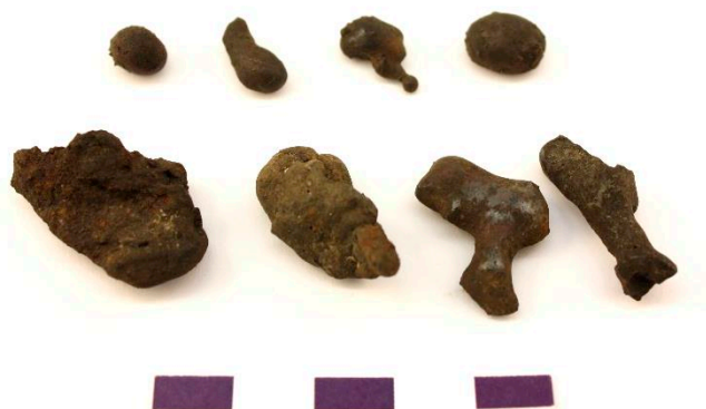
Figur 13. Del av 122:231, med slaggsträngar och slaggdroppar.
