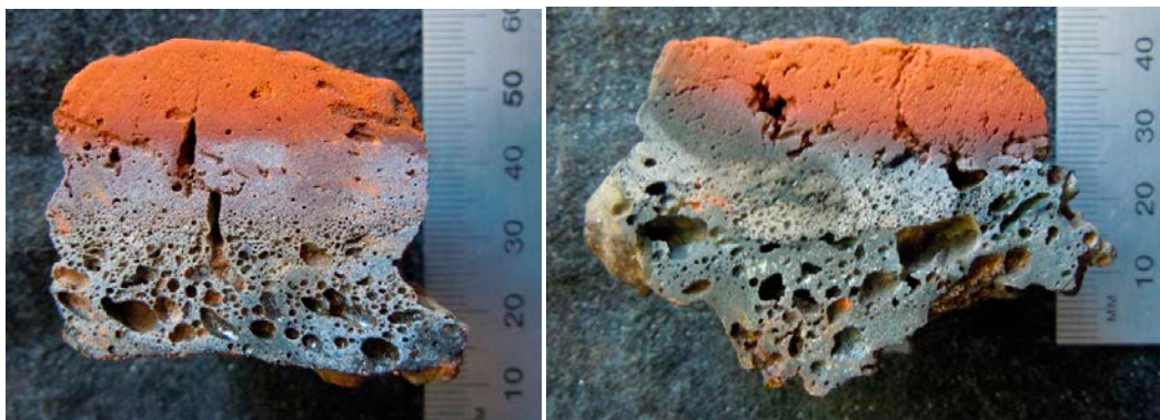
Fig. 1. Två genomskurna ugnsväggsfragment från F186, Godegård – a till vänster, b till höger. Båda har tydliga, snarlika värmegradienter. På insidan av b finns ett upp till 1cm tjockt lager av slag.
