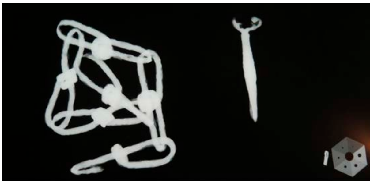
Figur 2. Röntgenbild av fynd före konservering. Vitare yta representerar ett tjockare material eller ett material med högre densitet, i detta fall mer välbevarade ytor.
